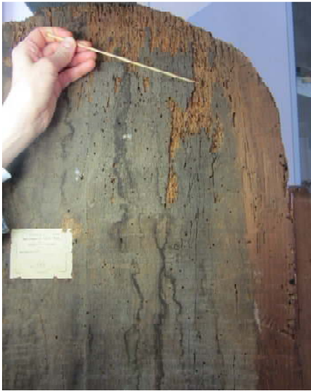
Figura 4 – Prelievo di un frammento ligneo della superficie ingrigita, in corrispondenza della zona fortemente danneggiata da attacchi xilofagi
