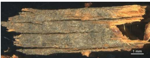
Figura 9 – Immagini allo stereo-microscopio a diverso ingrandimento del camp. N. 5, prelevato al centro del supporto da una zona ingrigita in corrispondenza di una chiazza verosimilmente causata dalla percolazione di acqua.
