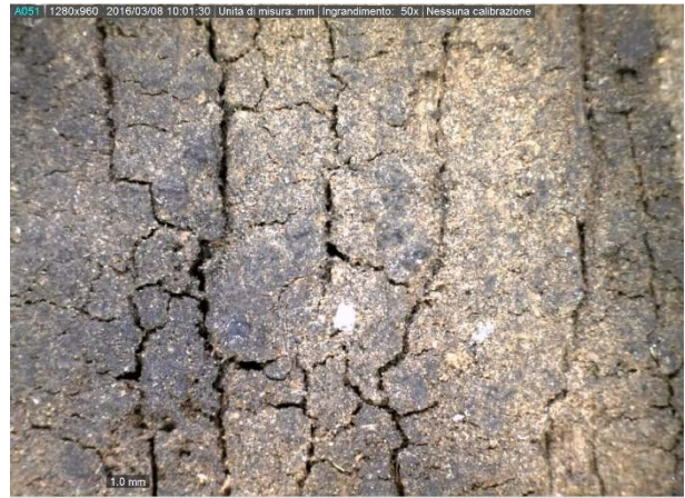
Figura 3 – Verso del supporto, osservazioni tramite microscopio portatile a livello della superficie ingrignata del legno, in corrispondenza delle tracce di percolazione
