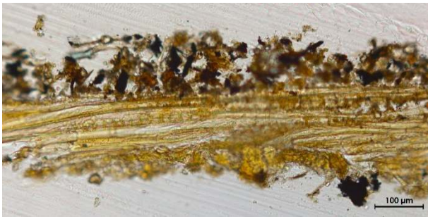
Figura 7 – Immagini al microscopio ottico a diversi ingrandimenti di una sezione tagliata dal camp. N. 1 dopo inclusione in resina. Si osserva la netta demarcazione tra il legno e lo strato soprastante formato da depositi brunastri dispersi.
