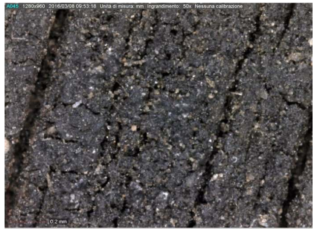
Figura 2 – Verso del supporto, osservazioni tramite microscopio portatile delle alterazioni cromatiche riferibili alla combustione
