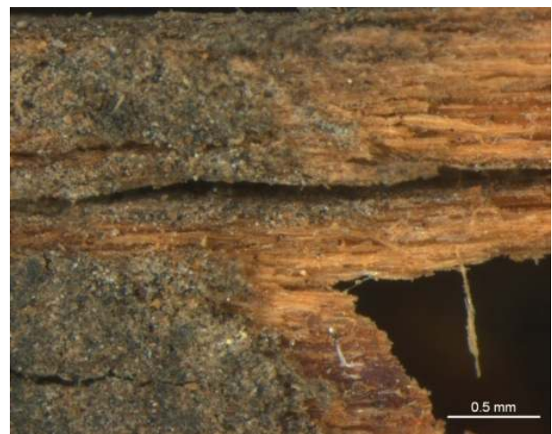
Figura 9 – Immagini allo stereo-microscopio a diverso ingrandimento del camp. N. 5, prelevato al centro del supporto da una zona ingrigita in corrispondenza di una chiazza verosimilmente causata dalla percolazione di acqua.
