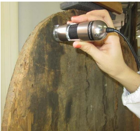
Figura 2 – Verso del supporto, osservazioni tramite microscopio portatile delle alterazioni cromatiche riferibili alla combustione
