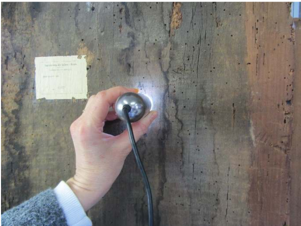
Figura 3 – Verso del supporto, osservazioni tramite microscopio portatile a livello della superficie ingrignata del legno, in corrispondenza delle tracce di percolazione
